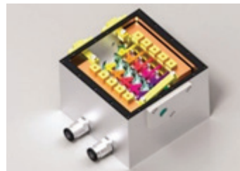
手のひらサイズ (従来比約 1/25) の フォトニック結晶レーザーモジュール (プロトタイプ)
